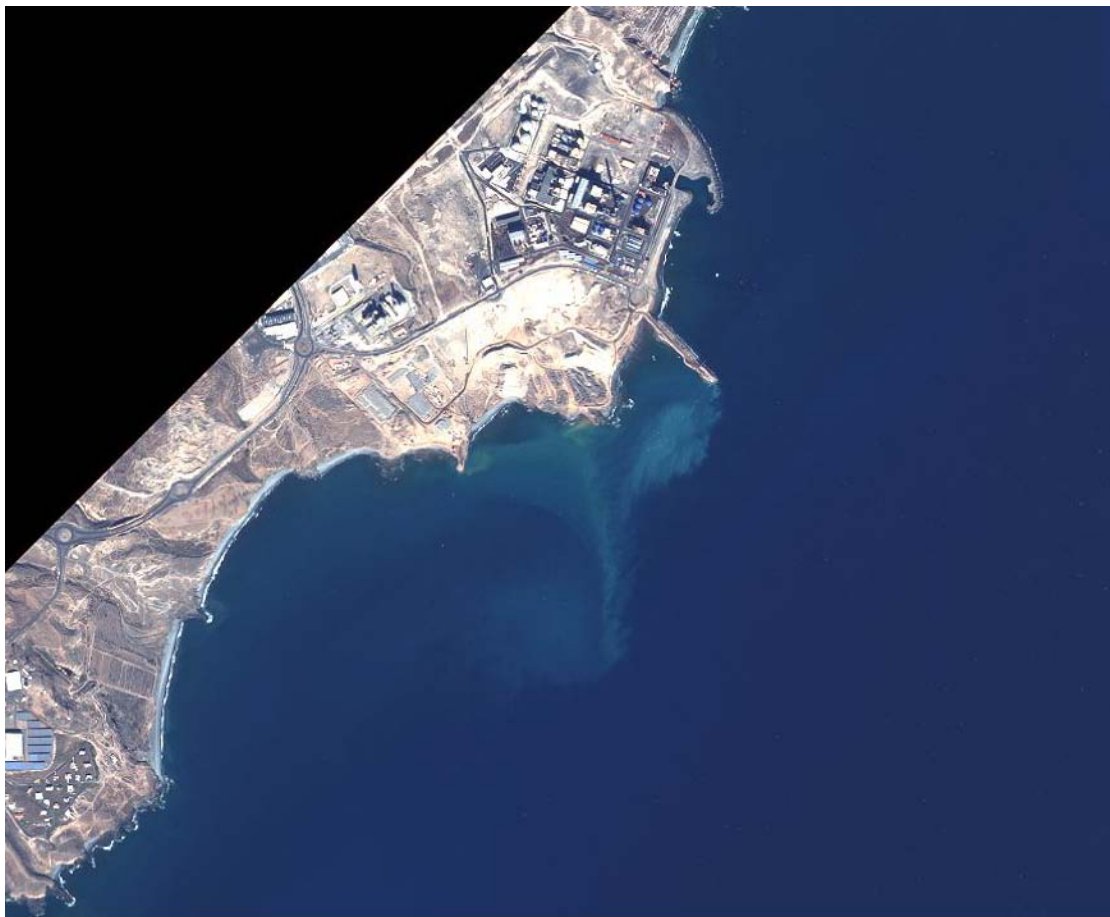
Figura 4. Detalle de la pluma de turbidez tomada por el satélite Worldview II el 1 de diciembre de 2011. La zec comienza a partir del borde inferior de la foto. La pluma cambia con las corrientes de marea y, en principio, debería mostrar un avance neto hacia el SW siguiendo la dirección de la corriente de Canarias imperante. No obstante, se aprecian flujos y reflujos que pueden estar vinculados a la irrupción de las obras de abrigo del puerto, y cuya evolución requiere tiempo de estudio.
