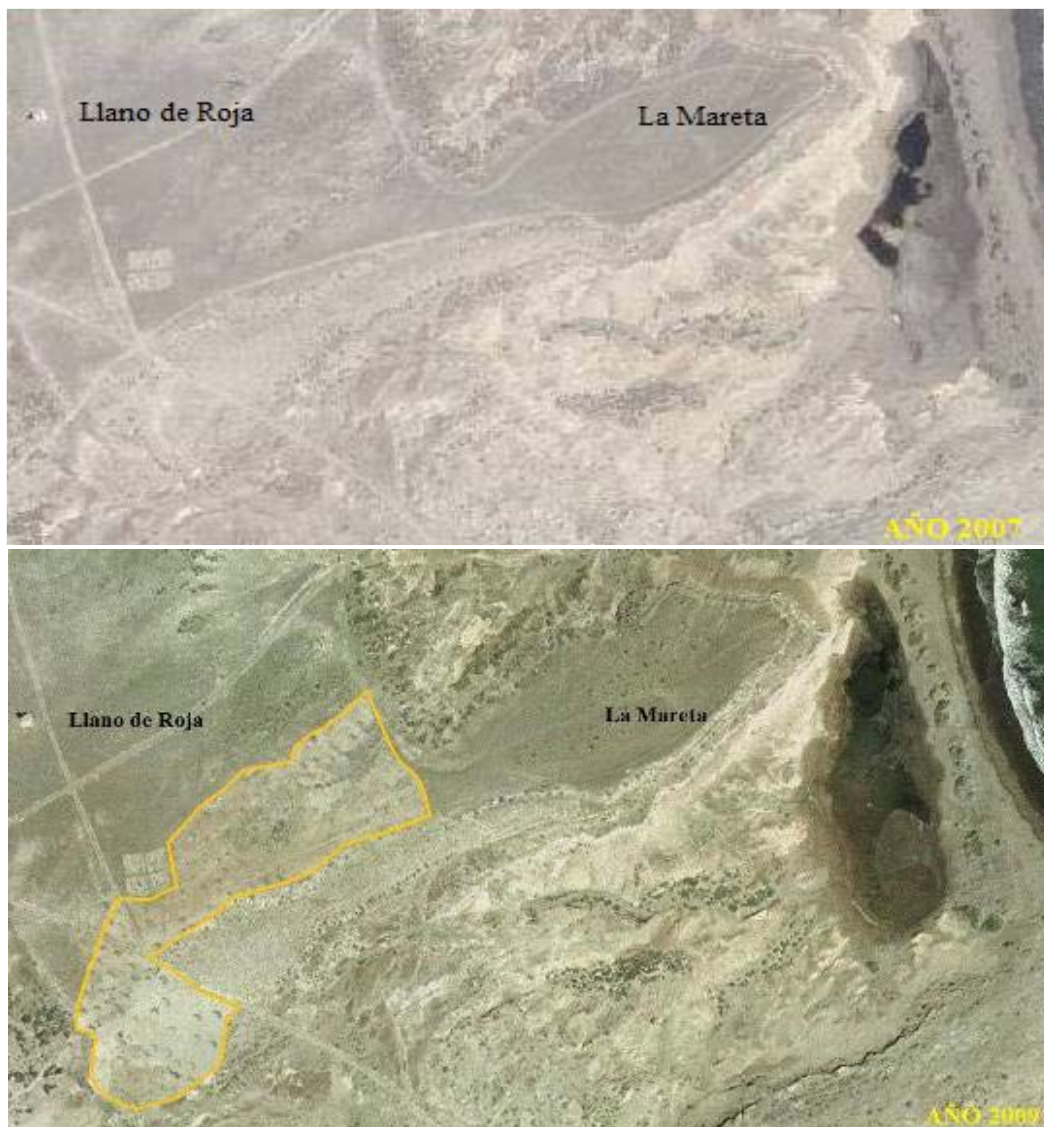
Figura 16. Comparación visual del área de la actuación antes (2007) y después (2009) de ejecutar los amontonamientos retenedores de arena (polígono delimitado en amarillo) y la recuperación de La Mareta, a la derecha de la foto. Fuente Grafcan (WGS 84 GSD: 40).
