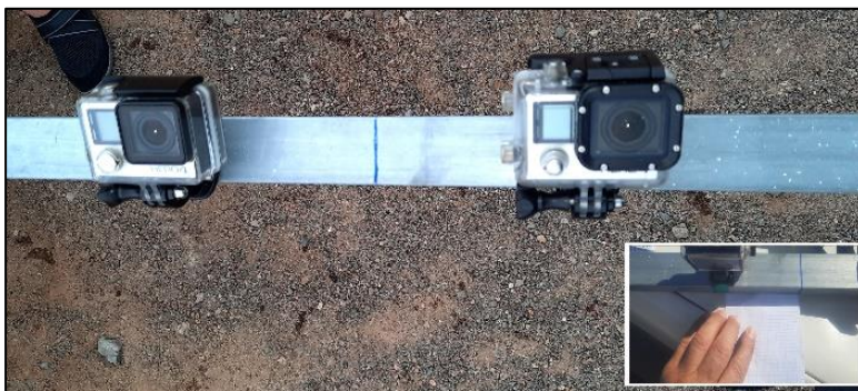
Figura 127 Cámaras centradas en la pértiga. En el recuadro, momento de comprobación de la equidistancia al centro de ambas unidades
