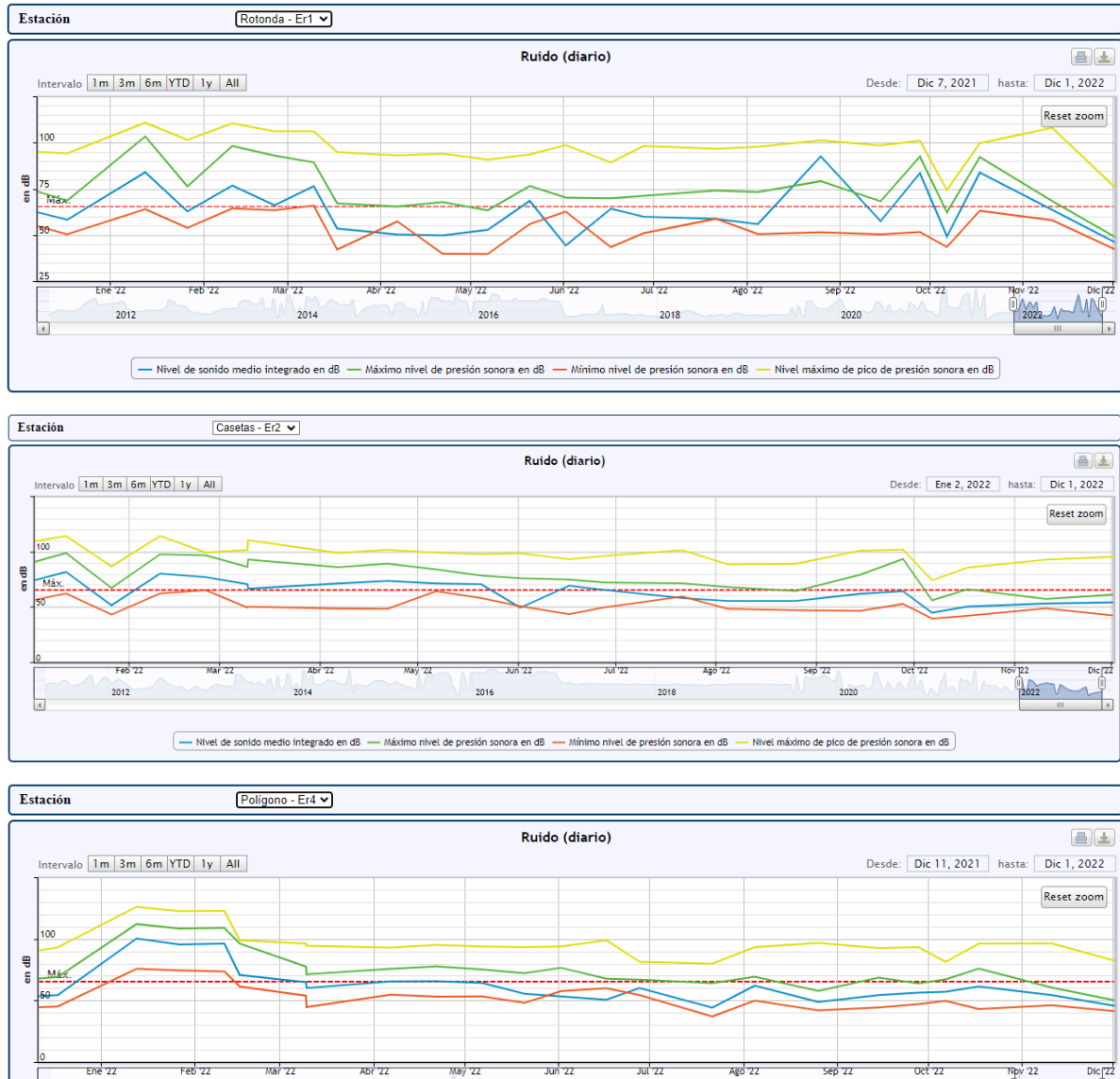
Figura 13. Medición del ruido diario en 2022 (1 minuto cada quincena) en las tres estaciones.
