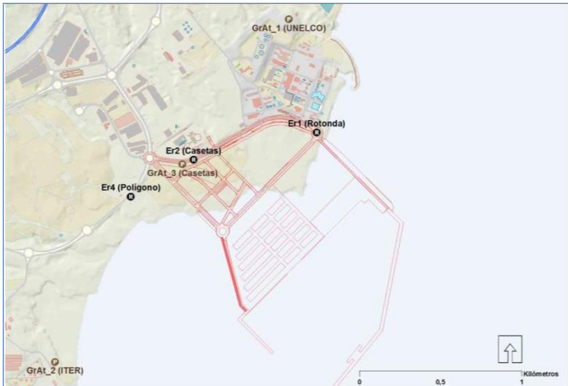
Figura 12 Estaciones de medición de partículas en suspensión (GrAT) y de ruido (Er)
