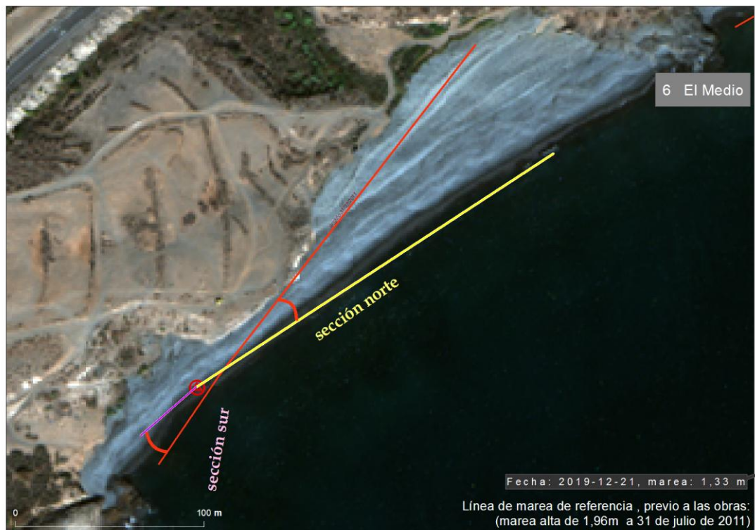
Figura 46: Nuevo modelo de playa con articulación para medir basculamiento. Playa de El Medio: 2011 (rojo) y 2019 (norte amarillo y sur púrpura). El ángulo a medir en rojo.
