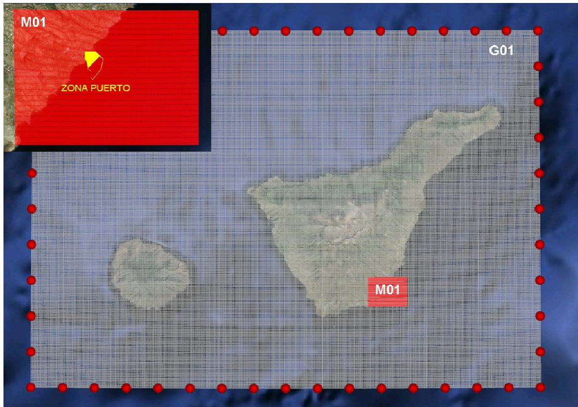
Figura 2.22 Mallas SWAN utilizadas para la transferencia del oleaje desde profundidades indefinidas hasta la costa.
