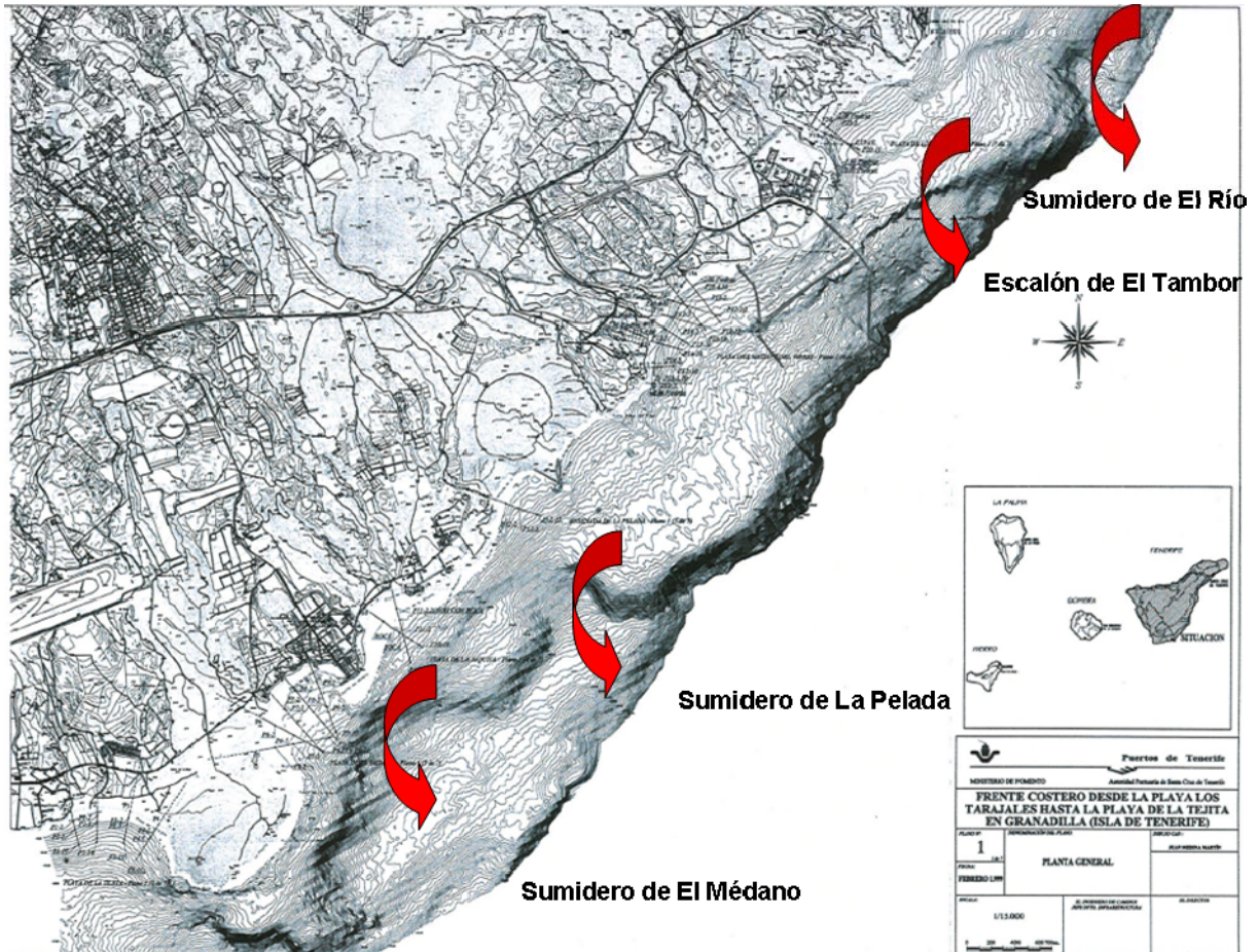
Figura 3.20. Zonas de la batimetría que actúan como sumideros de sedimento
