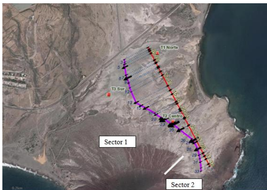
Figura 27. Trampas de arena (cuadrados rojos) y transecto evaluado. Las flechas negras indican la intensidad del flujo en los tramos señalados. Año 2017 (basado en 258 días de medida)
