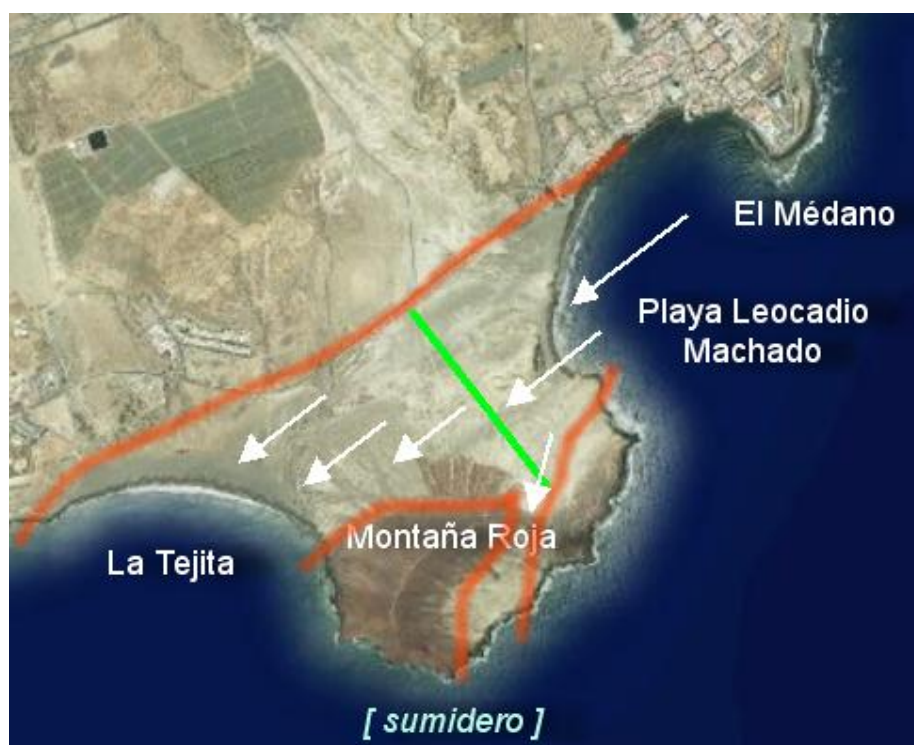
Figura 26. Franja de transporte eólico de arenas desde la bahía de El Médano hacia la de La Tejita
