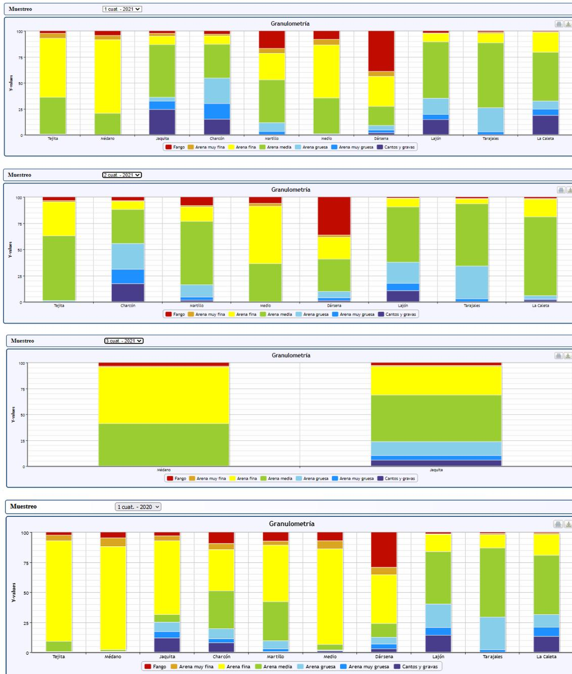
**Figura 108. Composición granulométrica de 100 gr de sedimentos a lo largo de la costa de Granadilla de SW a NE en 2020: arriba 1<sup>er</sup> muestreo realizado, medio 2<sup>a</sup> muestreo y abajo el último.**
