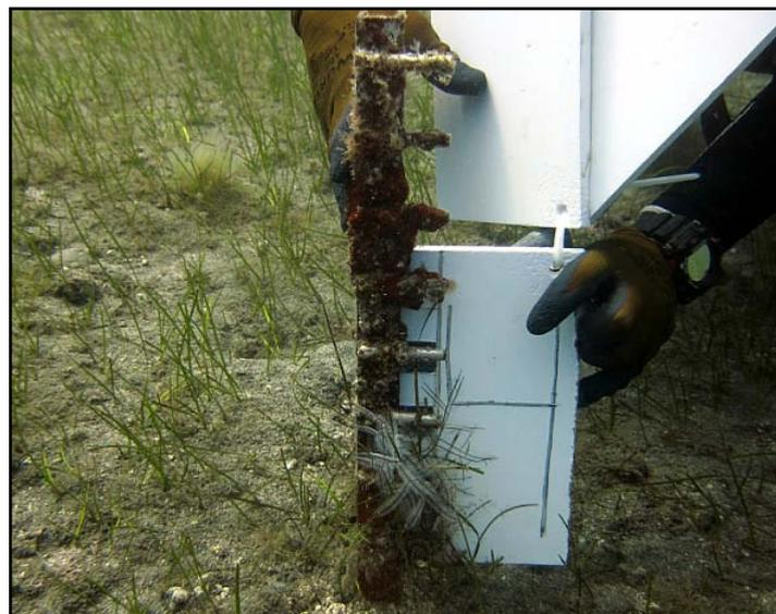
Figura 39. Estaca pentametrada y pizarra indicadora del número de estaca para la toma de foto
