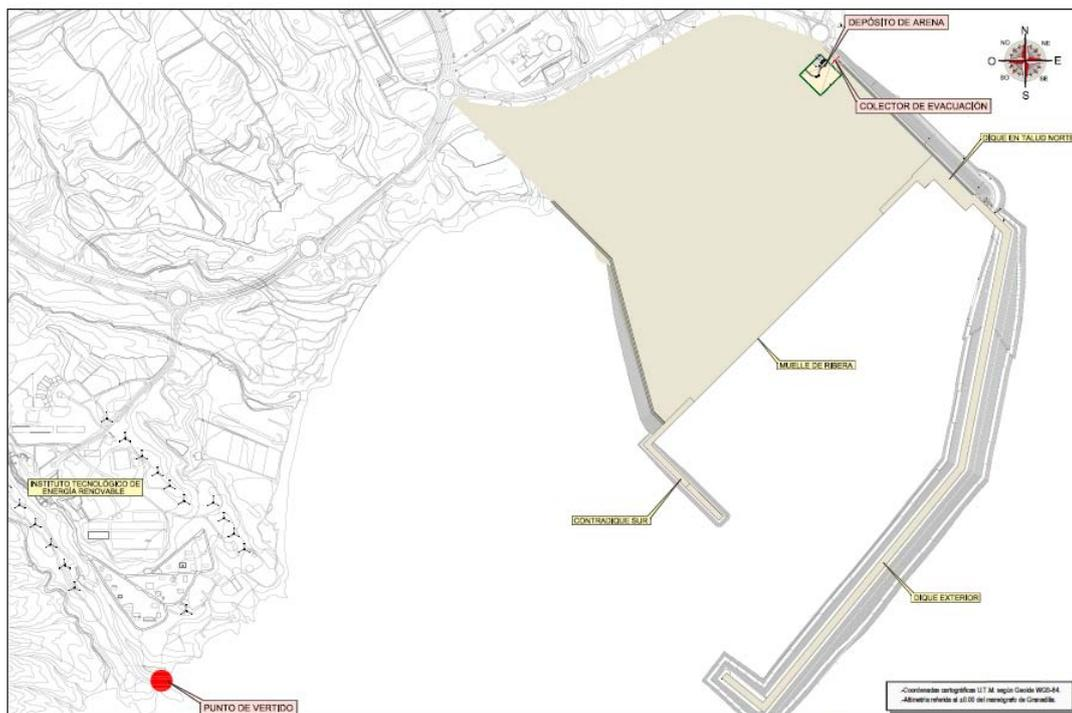
**Figura 15. Ubicación del depósito de arena y punto de vertido de la alternativa adoptada**
