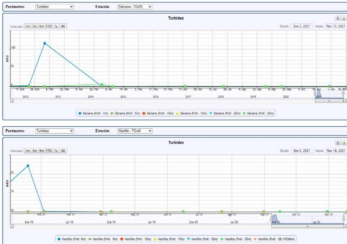
**Figura 91. Turbidez (NTU) registrada en 2021 con sonda multiparamétrica en las estaciones ubicadas en el interior del puerto: Dársena (TGr09) y Martillo (TGr40)**
