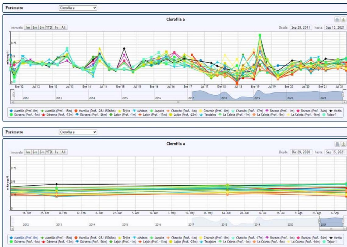
**Figura 92. Arriba: evolución de la concentración de clorofila proveniente de análisis de laboratorio entre 2011 y 2021 en todas las estaciones. Abajo: Concentración de clorofila a lo largo del 2021**
