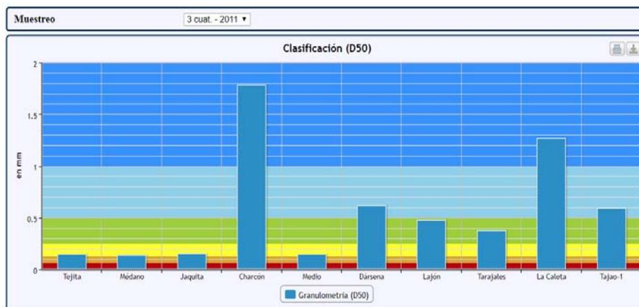
Figura 106. Clasificación D50 de los sedimentos en el tercer trimestre de 2011 (referencia)
