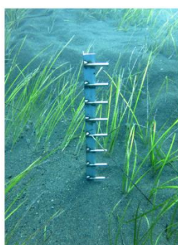
Figura 66. Estación 13 (Abejera). Nuevo modelo de estaca de acero inoxidable con marcas cada 5 cm (izda.) y variación de la altura de arena en la serie de estacas, de la 0 (más próxima a tierra) a la 4 (más alejada).
