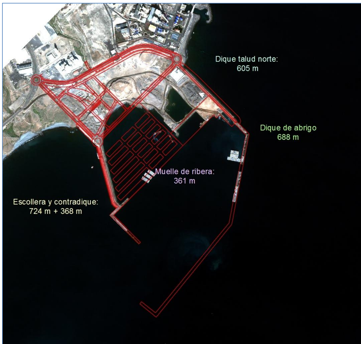
Figura 5. Situación de las obras de abrigo y contradique en del puerto de Granadilla en diciembre 2015.
