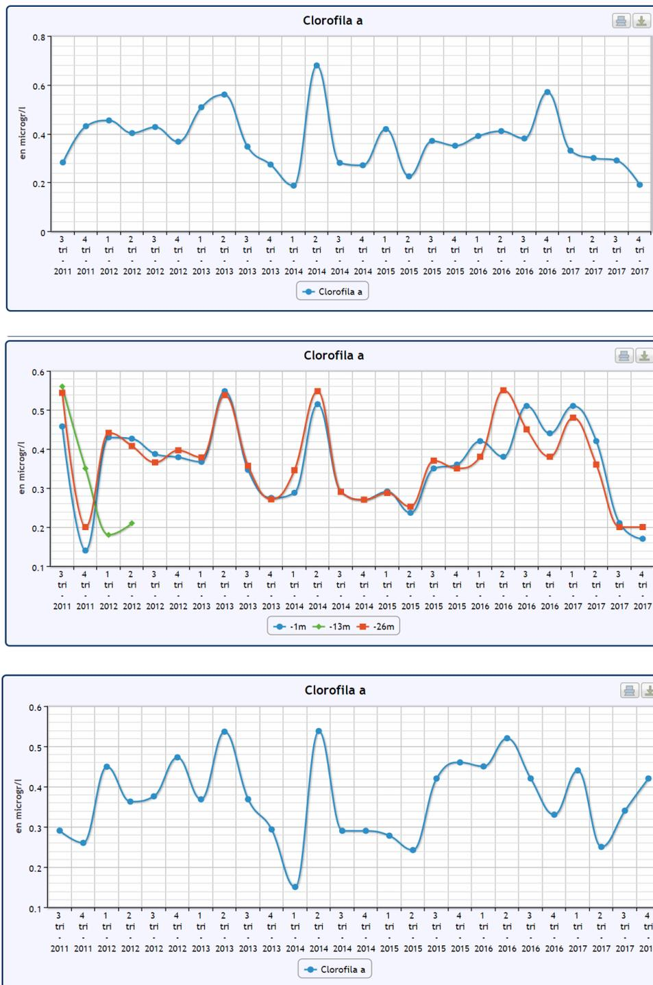
Figura 69. Evolución 2011-2017 de la clorofila a en la estación Tejita (arriba), Dársena (medio) y Tarajales. Equivalencia 1 µg/l = 1 mg/m<sup>3</sup> de clorofila a
