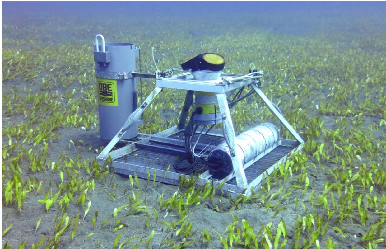
**Figura 157. Perfilador SonTex ADP 500 Khz fondeado en estación TGr-18 en un caulerpal**
