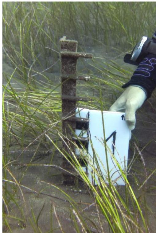
Figura 55. Estaca decimetrada y pizarra indicadora del número de estaca para la toma de foto
