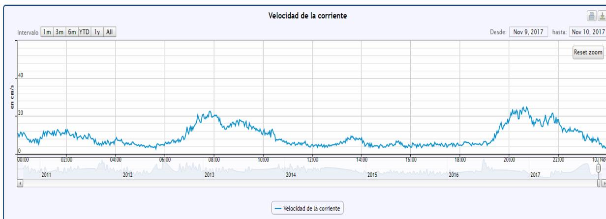
**Figura 41. Patrón diario (09-11-2017) de la velocidad de la corriente en la boya de Granadilla. Se observan dos picos en velocidad que coinciden con los momentos previos a la bajamar**
