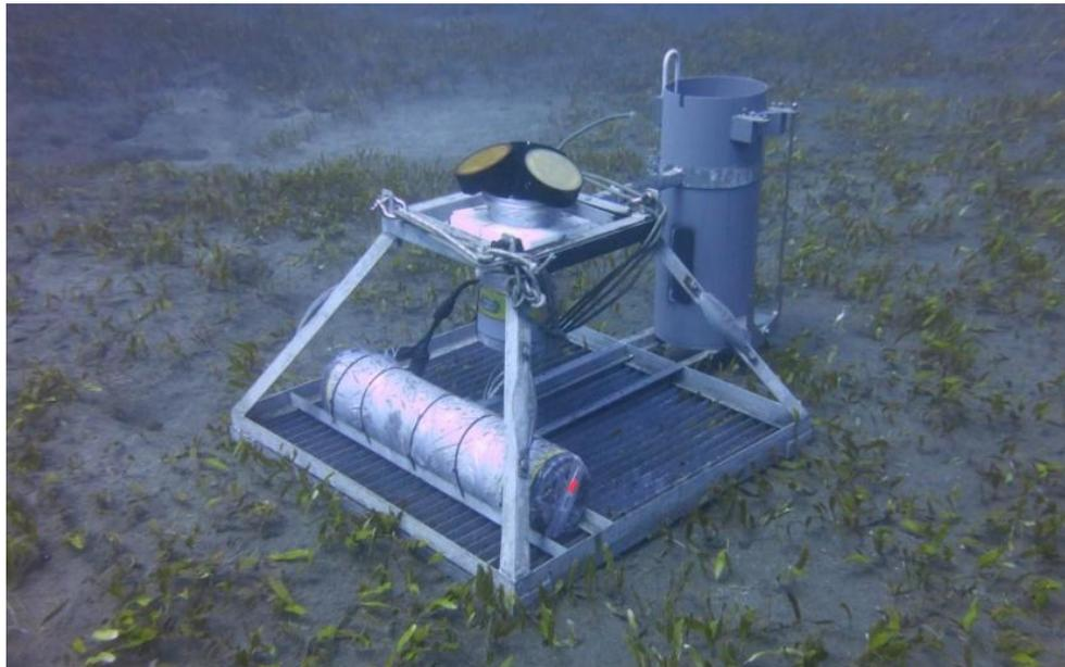
**Figura 46. Perfilador *SonTex* ADP 500 Khz fondeado por fuera de la bocana del puerto. Estación TGr-43. Fondo de arena con comunidad de *Caulerpa***
