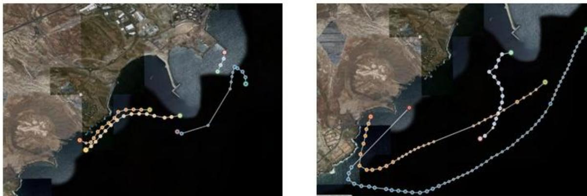
**Figura 44. Derrota de alguna de las boyas de deriva: marea llenante (izquierda) y vaciante (derecha)**
