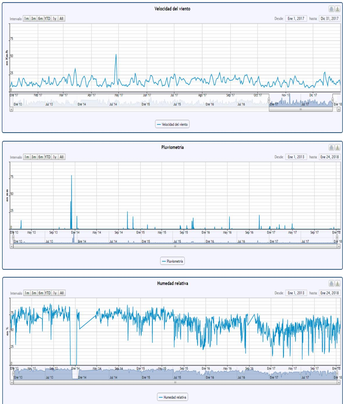
Figura 14. Velocidad del viento, pluviometría y humedad relativa en la estación del OAG en tierra (2017)
